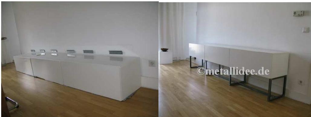
Herstellung und Montage von einem Gestell für ein Sideboard aus Stahl Vierkantrohr 30x30x2mm mit den Maßen 380x420x3065mm. Bestehend aus 4 Stck. Rahmen und 6 Stck. Zwischenstücken. Das Gestell in die Wohnung getragen und zusammengeschaubt. 2-tlg. Ausführung (verdeckt).
